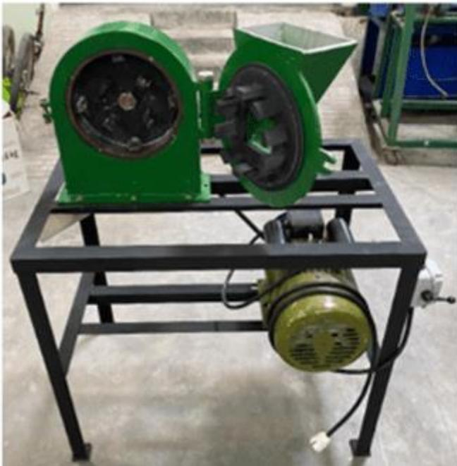
**Gambar 4.** Mesin Pencacah Plastik
