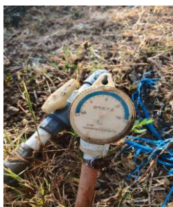
Gambar 3. Tekanan Biogas pada Manometer
