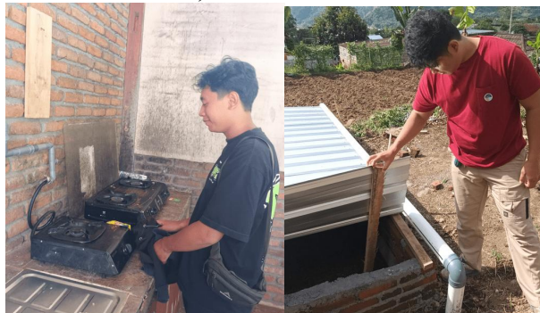
Gambar 4. Implementasi dan Inovasi penggunaan biogas konversi menjadi bahan bakar kompor gas, dan bahan padat dijadikan pupuk kandang.
