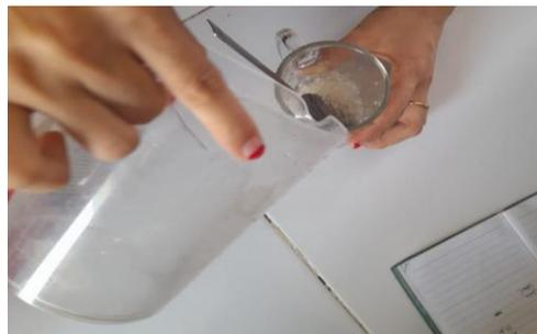
Gambar 7. Pelarutan CMC (*Carboxy Metil Selulosa*)
