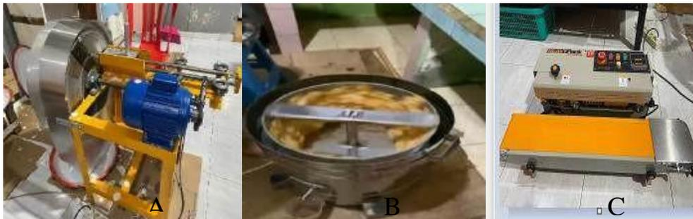
Gambar 2. Alat tepat guna yang diberikan pada mitra: a= perajang singkong kapasitas 1 ton, b= spiner kapasitas 5 kg dan c= continuous band sealer
