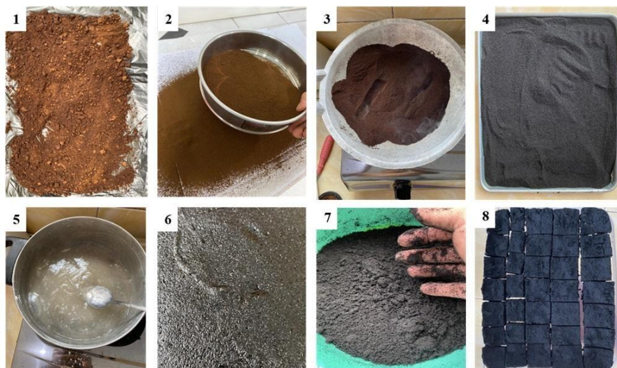
Gambar 2. Proses Pembuatan Biobriket berbahan dasar ampas kopi
