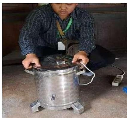
Gambar 4. Mesin Spinner
