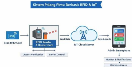
Gbr. 1 Arsitektur Palang Pintu Berbasis RFID & IoT
